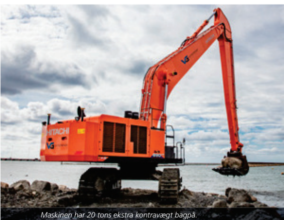
Maskinen har 20 tons ekstra kontravægt bagpå.
