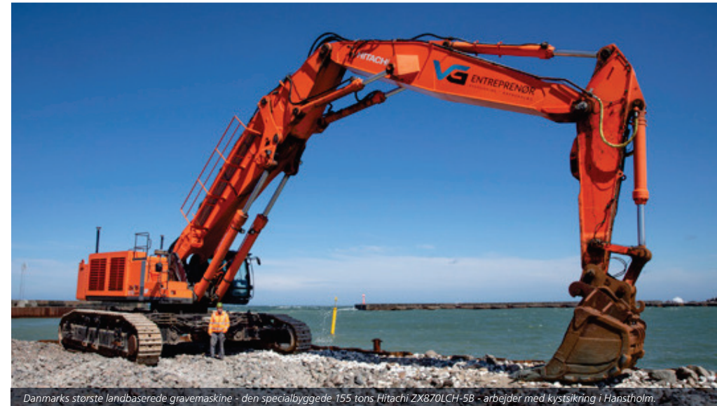
Danmarks største landbaserede gravemaskine - den specialbyggede 155 tons Hitachi ZX870LCH-5B - arbejder med kystsikring i Hånstholm.
